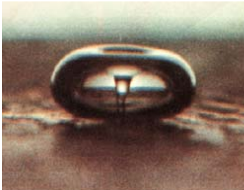
Figuur 4.1 Waterstraal in microbel bij vast oppervlak [Gogate, 2002].
