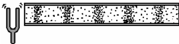
Figuur 2.2 Een stemvork veroorzaakt een longitudinale geluidsgolf in een buis, hier zijn de compressie en rarefactie fases van de lucht duidelijk te zien [Henderson, 2007].
